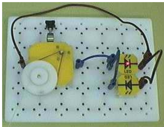
Slika 3.1: Delovanje elektromotorja kot generator, levo stikalni načrt in desno postavitev eksperimenta.
